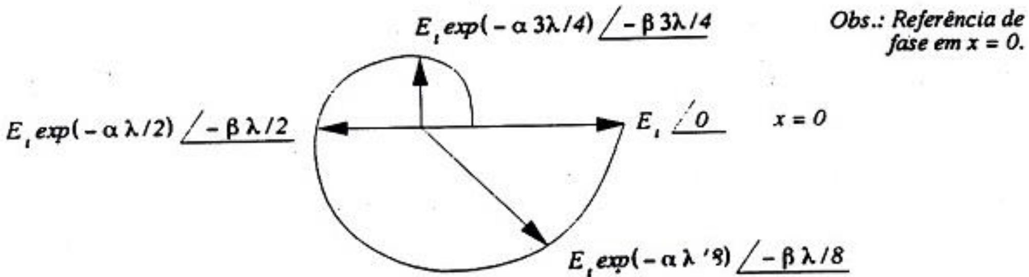
*Fig. A. 2 – Fasores de tensão para  $x = 0$  (no eixo real),  $x = \lambda/8$ ,  $x = \lambda/2$  e  $x = 3\lambda/4$ .*
