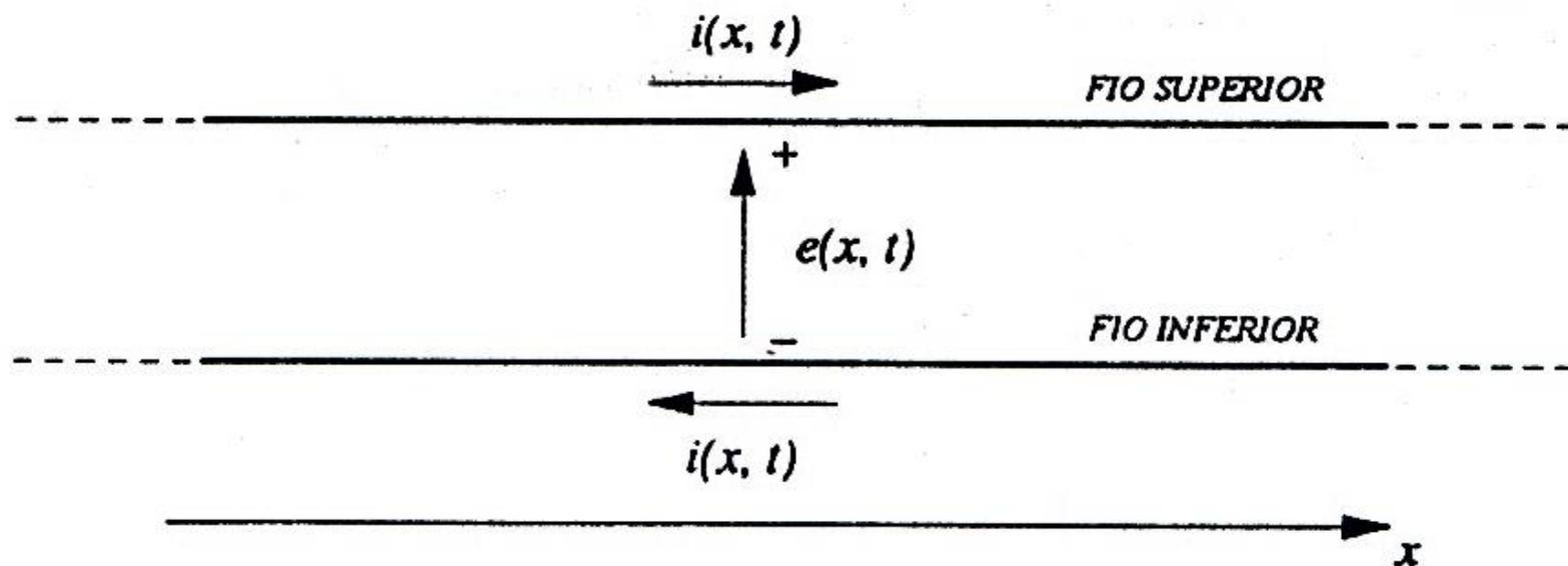
⇒ Fig. 3 – Convenção de sinais para tensão e corrente na linha
