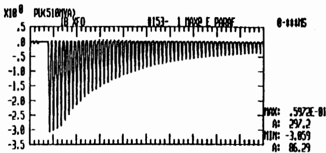
Figura 5.26 - Energização de Transformador no Instante em que o Fluxo é Igual ao Fluxo Residual
