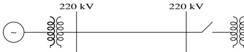
Figura 4 - Sistema de Transmissão de 220 kV para Modelagem no ATP
