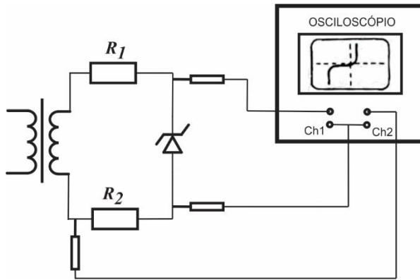
Utilize  $R_1=10\text{K}\Omega$ ,  $R_2=1\text{K}\Omega$  e diodo 1N4739. Coloque o osciloscópio em modo XY. Descubra a tensão zener e a tensão de modo direto.
