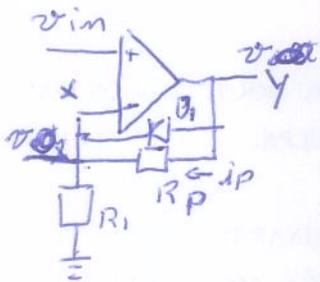
• Com  $R_p$ , a realimentação sempre existirá, portanto  $v_{out} = v_x = v_{in}$ , independente de  $v_{in}$ .
