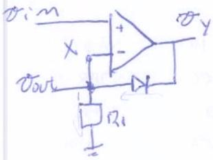
•  $v_{in} > 0 \Rightarrow$  corrente de  $Y \rightarrow X \Rightarrow$  diodo aberto  $\begin{cases} v_Y = V_{CC}, v_+ > v_- \\ v_X = v_{out} \\ v_{out} \\ i_d = 0 \end{cases}$
