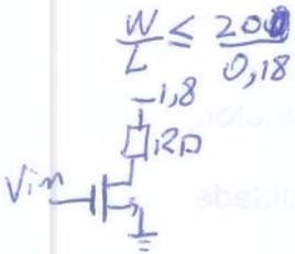
$P \leq 1 \text{ mW} \Rightarrow 1,8 \cdot I_D \leq 1 \text{ mW} \Rightarrow I_D \leq 5,5556 \cdot 10^{-4} \text{ A}$
