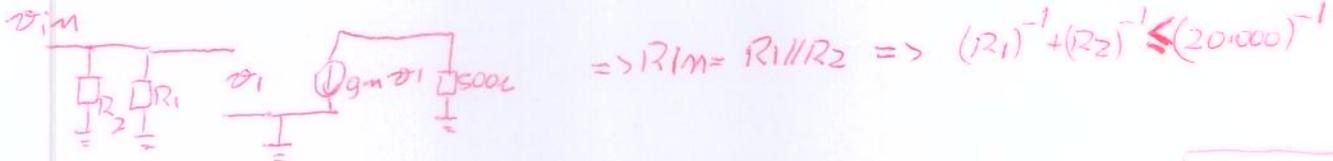
$$\Rightarrow R_{in} = R_1 \parallel R_2 \Rightarrow (R_1)^{-1} + (R_2)^{-1} \leq (20 \cdot 1000)^{-1}$$
