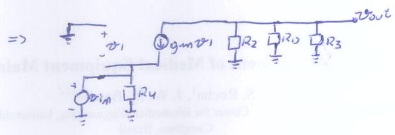
$\Rightarrow v_{out} = -g_m v_1 \cdot (R_2 \parallel R_3 \parallel R_L)$
