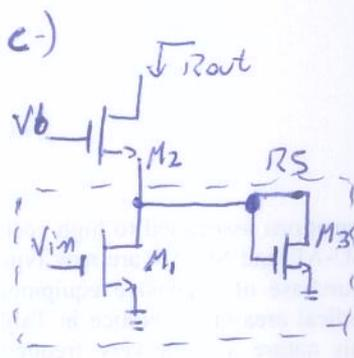
obs: No modelo de pequenos sinais  $V_b = V_{in} = 0$ , portanto, vou considerar  $R_{S2} = R_{M1} \parallel R_{M3}$ , ao invés de  $R_{D1} = R_{M2} \parallel R_{M3}$
