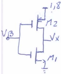
$$\left(\frac{W}{L}\right)_1 = \frac{10}{0,18} ; \left(\frac{W}{L}\right)_2 = \frac{30}{0,18} ; \lambda = 0,1 \text{V}^{-1} ; V_X = 0,9 ; V_B$$
