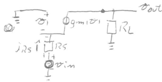
$$\circ v_{out} = -g_{m1}v_{o1} \cdot R_L$$
