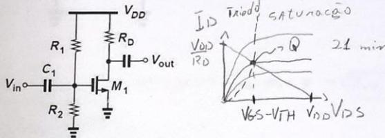
• Fronteira  $\Rightarrow V_{DSQ} = V_{GSQ} - V_{TH} \Rightarrow V_{DSQ} = V_{GSQ} - 0,5$  (1)
