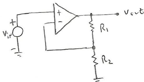
$$\text{Assim, } V_{out} = 0,5 \left(1 + \frac{R_1}{R_2}\right) \sin(\omega t)$$
