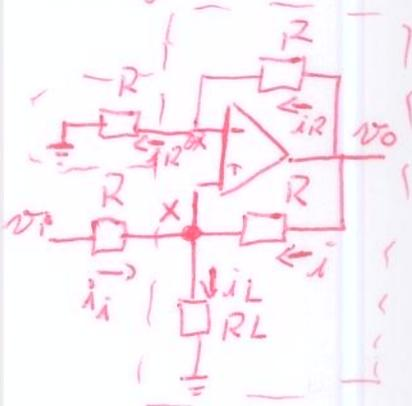
$$i_R = \frac{v_o - v_x}{2R} = \frac{v_x}{R} \Rightarrow v_x = \frac{v_o}{2} \Rightarrow v_o = 2v_x$$
