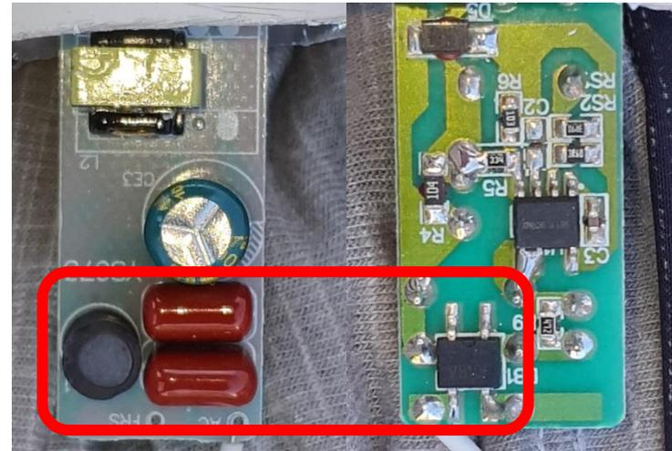
Circuito de alimentação da luminária com melhoria de FP (retificador monofásico com filtro CLC de entrada, seguido de conversor CC-CC do tipo *buck*).
