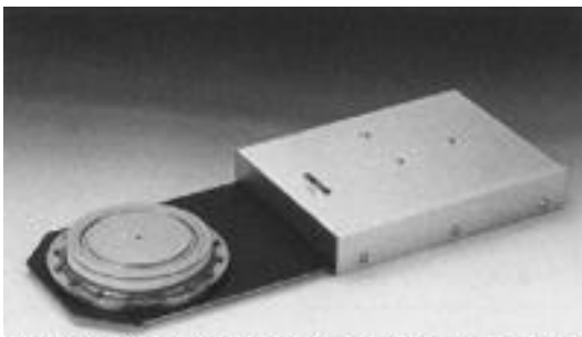
IGCT e seu circuito de comando integrado ao dispositivo de potência e circuito de inversor com IGCT.
