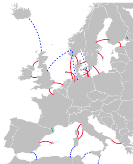
Figura 4.24 Linhas HVDC na Europa: existentes (vermelho), em construção (verde), planejadas (azul). http://en.wikipedia.org/wiki/High-voltage_direct_current
