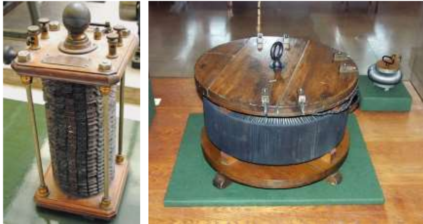
“Gerador secundário” de Gaulard e Gibbs 8 (esq.) e Transformador de Bláthy 9 (dir)
