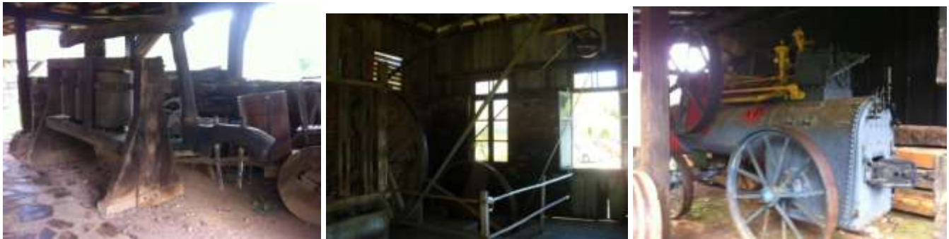
Transmissão mecânica de força motriz: tração animal, roda d'água e máquina a vapor
